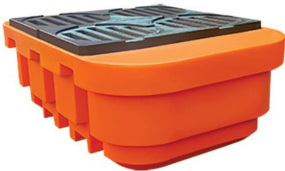
Pallet de Contenção IBC para 4 Tambores 1000 Litros é fabricado em Polietileno de Média ou Alta Densidade (PEMD ou PEAD) pelo processo de rotomoldagem sem soldas ou emendas e utilizados para assegurar a contenção de vazamentos. Sua principal função é impedir que líquidos químicos, inflamáveis, ácidos e corrosivos que vazem dos tambores contaminem o solo o ambiente e as pessoas.
