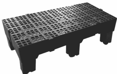
Os Estrados de Plástico Com Prolongador 41cm x 82cm são fabricados em Polietileno de Alta Densidade (PEAD) ou Polipropileno (PP), atendendo a todas as normas vigentes da Agência Nacional de Vigilância Sanitária (ANVISA). Com capacidade para 2 ton/m<sup>2</sup>, são extremamente resistentes e duráveis.
