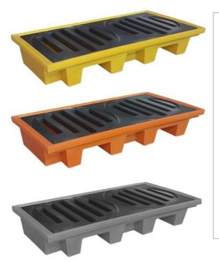
Os Pallets de Contenção – 2 Tambores – 75L são fabricados em Polietileno de Média ou Alta Densidade (PEMD ou PEAD) pelo processo de rotomoldagem sem soldas ou emendas e utilizados para conter substâncias líquidas provenientes de vazamentos no processo de movimentação e armazenagem de tambores, galões e outros recipientes. De estrutura leve, podem ser facilmente manipulados com empilhadeiras e paleteiras.
